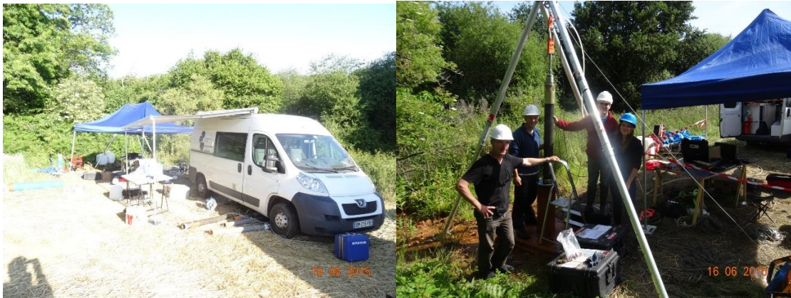
Figure 5 : Laboratoire mobile sur le site de Plomeur (à gauche) pour mesurer les propriétés hydrochimiques et microbiologiques dans des fractures à différentes profondeurs isolées par un obturateur (à droite). (Bochet et al. 2020 25 )
